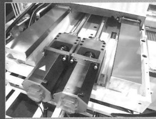
1998 - 超高速金型加工機 「スパークカット/Sparkcut」の開発。 15万回転の高速度主軸、新開発2軸 対抗送りによる切削送り毎分100m （加速度2G）、金型部品のプロセス 時間を1/10以下に短縮。金型 加工時間(1/10)に短縮 （第1回中小企業庁長賞賞）受賞！
