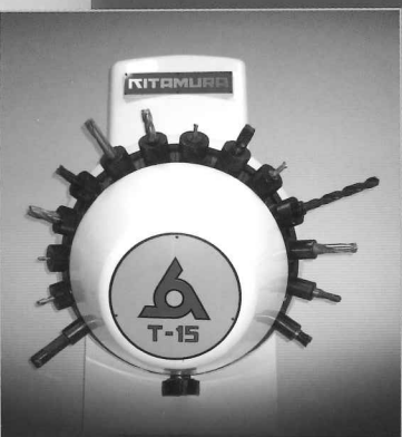
1971 - 立形マシニングセンタの開発に成功 千手観音像をヒントに工具交換装置を開発、世界最速 の工具交換を実現。（世界特許） 12本の工具交換装置を備えた「T-12」の量産開始。 工具交換時間の2秒は、世界最速。 （世界24ヵ国特許取得）
