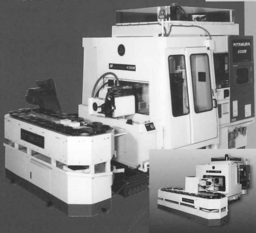
1985 - 同時5軸制御多面加工マシニングセンタ 「Mycenter-H300スーパーセル」を開発、販売開始。 世界で初めての10回のクランプでクランプ床以外の すべての加工が可能になる。高精度加工と 72時間無人加工を達成し、自動化に貢献。 世界特許取得(10ヵ国)
